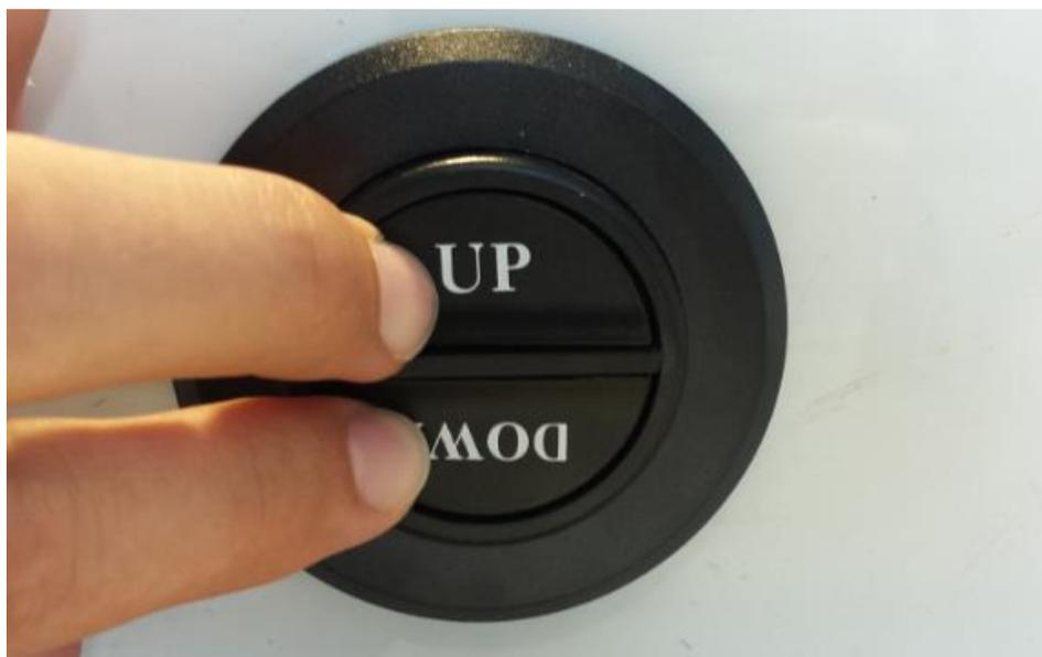
**Schritt 7:** Noch während Sie die UP- und DOWN-Taste gedrückt halten, stellen Sie die Stromversorgung zwischen Akku und Schaltschrank wieder her. Die Stromversorgung wird wiederhergestellt, indem die rot eingekreisten Stecker wieder miteinander verbunden werden.
